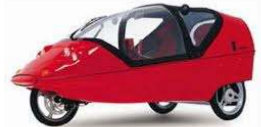
TWIKE (Veículo híbrido que combina eletricidade com a força humana através de pedais)
