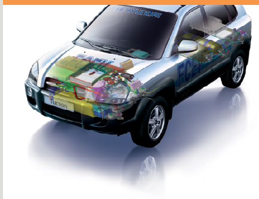
Célula de Combustível Elétrico
