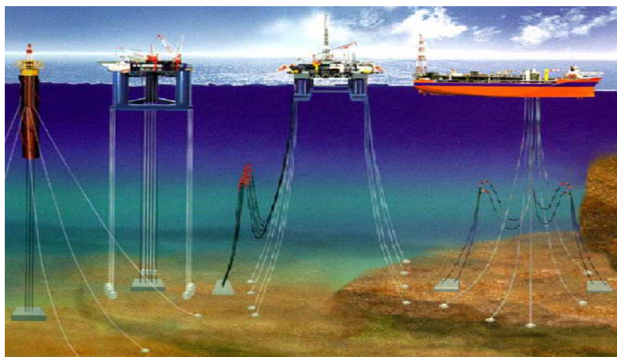
Figure 10. Les plates-formes flottantes (g. vers d.) : Spar (puits en surface), TLP (puits en surface), Semi-submersible (puits au fond) et FPSO (puits au fond)
